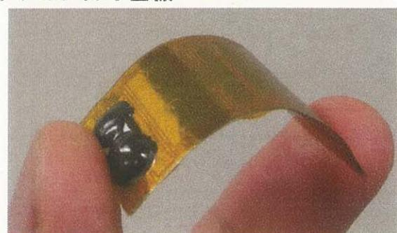
電子機器の必須要素であるプリント基板の面積や構造を活かして、基板自体が振動・変形発電する。
