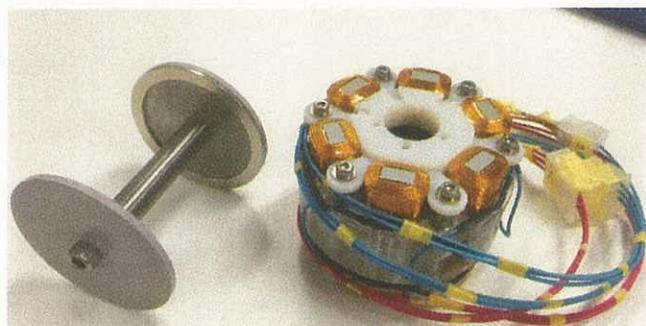
すべての自由度を能動的に磁気浮上制御することで、完全に非接触な状態で回転可能な磁気浮上モータ
