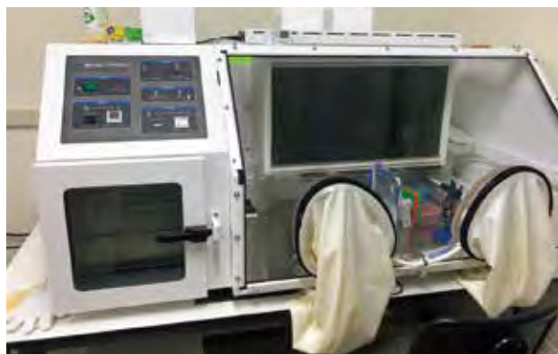
写真5 嫌気性細菌培養装置
